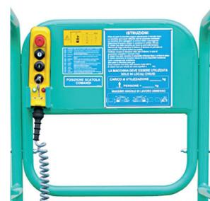
Pulsantiera estraibile per movimentazione agevole e in sicurezza. Completa di interruttore a chiave e fungo di emergenza.
