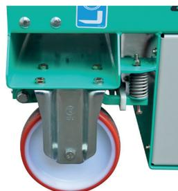
Ruote con freno automatico.
