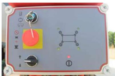
Control Box sull'albero, con interruttore di alimentazione, pulsante di emergenza e indicatore di interblocco stabilizzatori
