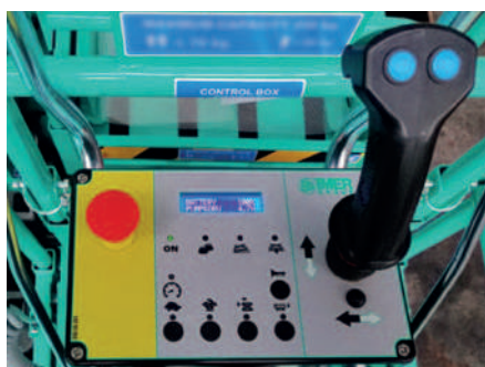
Quadro comandi sulla piattaforma con pulsanti capacitivi: semplicità e sicurezza di utilizzo
