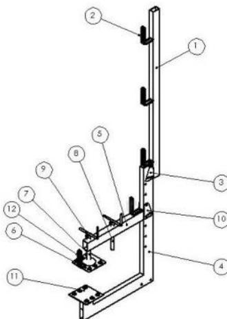
**Lo spessore massimo di ammorsaggio è di 42 cm e la profondità massima della morsa è di 42 cm da centro piastra (6) ad interno montante (4).**
